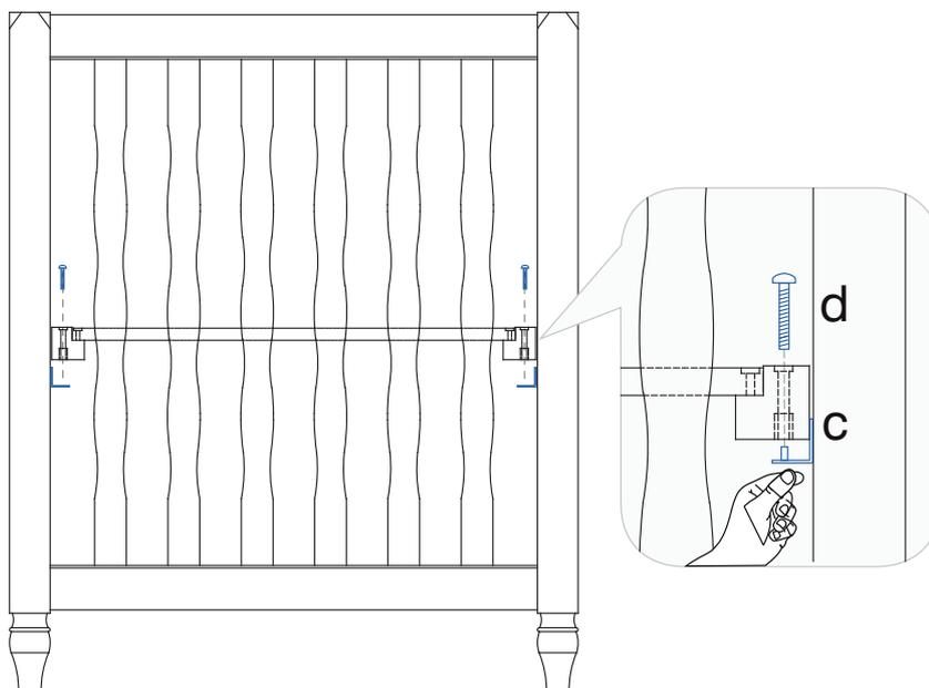
Para facilitar a montagem do estrado, segure a ferragem **c** através da grade lateral do berço, fazendo pequenos movimentos verticais no estrado enquanto direciona a ferragem **d** rosqueando, com o intuito de centralizar o parafuso no furo.
