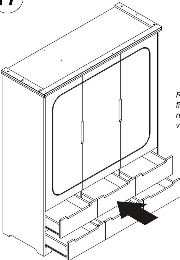
*Regulagem: as portas e as gavetas possuem regulagem, caso elas fiquem fora de posição, fazer o ajuste soltando os parafusos, reposicionar os acessórios e apertar novamente. Para as portas vide próxima página*
