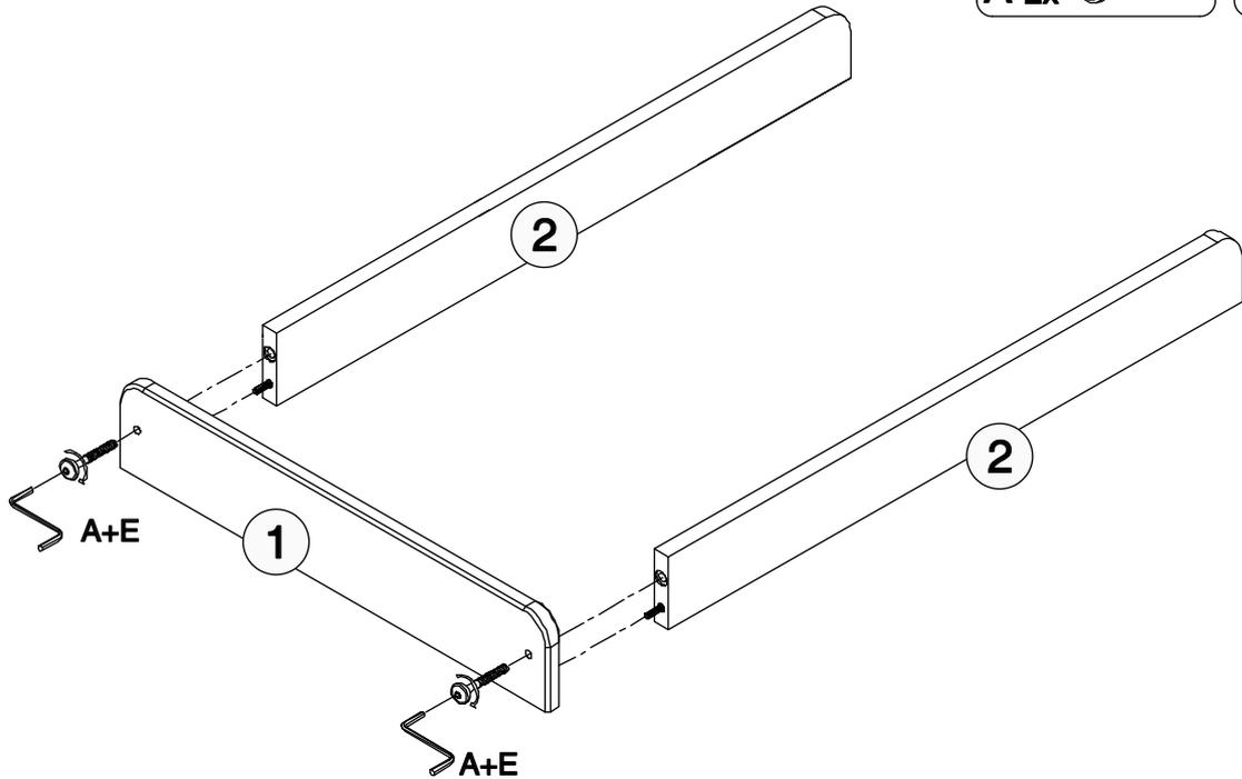
ENCAIXE A CAVILHA DA PEÇA 01 DO TROCADOR NO FURO ATRÁS DA CÔMODA CONFORME POSIÇÃO À SUA ESCOLHA
