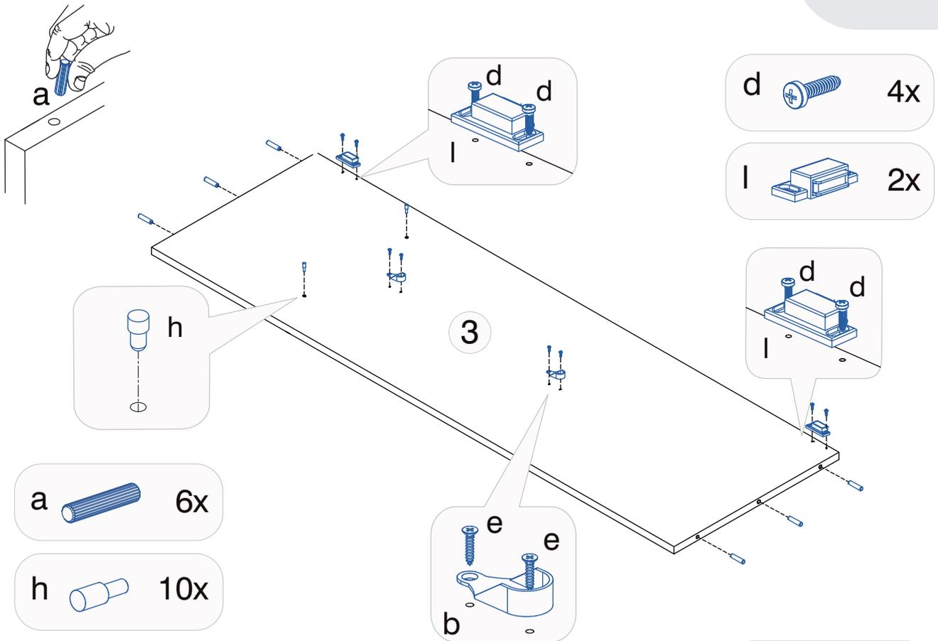
Colocar as ferragens necessárias em um lado da peça, depois vira-se esta peça, colocando-se neste lado o restante das ferragens previstas para esta etapa de montagem.
