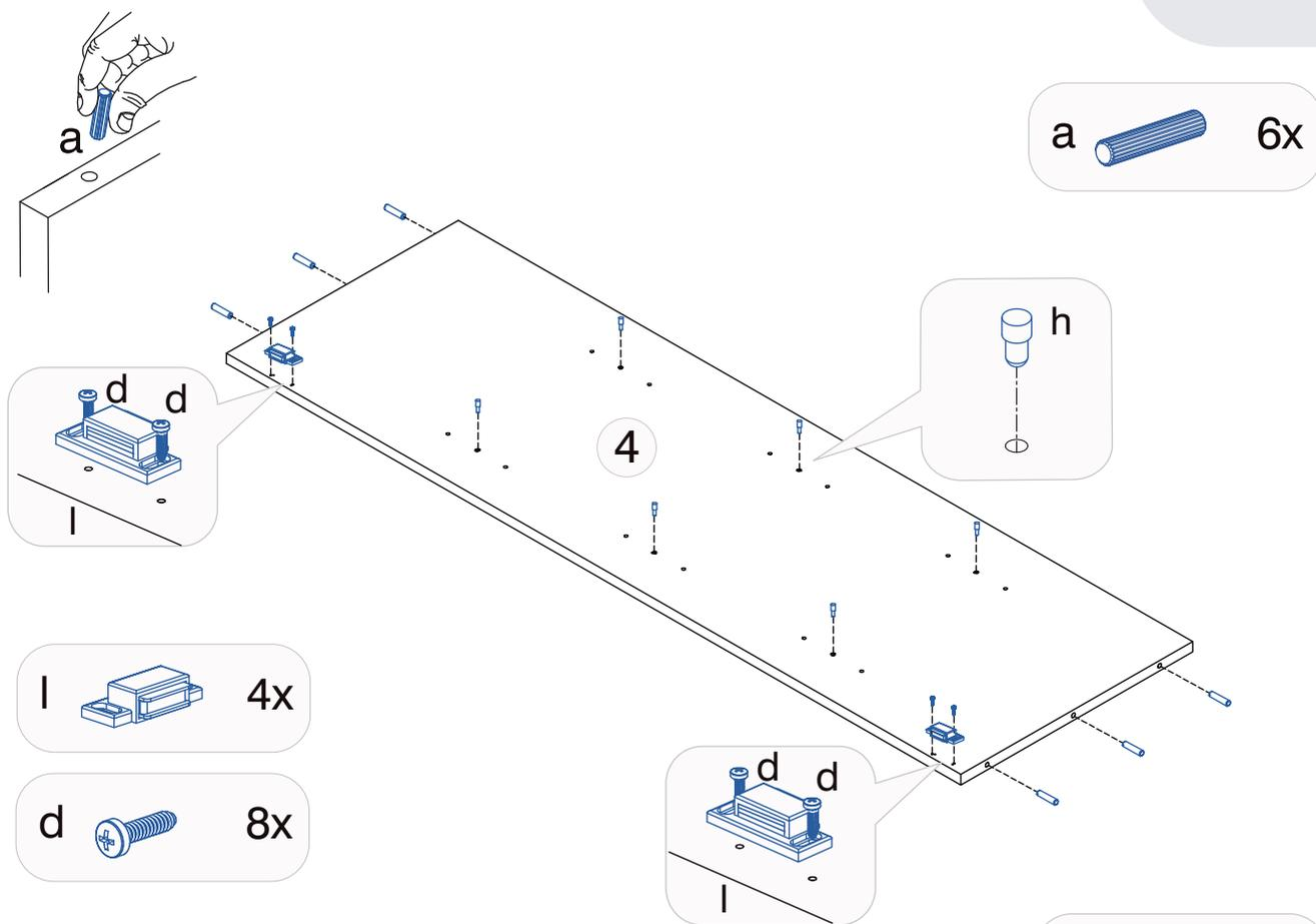
Colocar as ferragens necessárias em um lado da peça, depois vira-se esta peça, colocando-se neste lado o restante das ferragens previstas para esta etapa de montagem.
