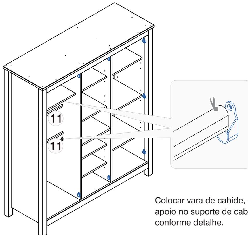
Colocar vara de cabide, observando o apoio no suporte de cabide, conforme detalhe.
