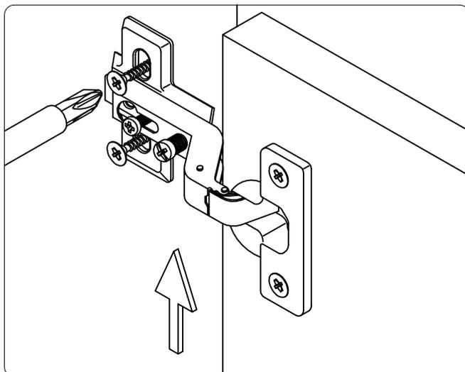
**Se a porta estiver fora de esquadro com relação a estrutura do móvel, ajustá-la apertando ou soltando o parafuso indicado na figura abaixo.**
