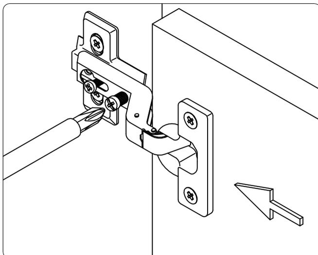
**Para alinhar a profundidade da porta em relação ao quadro do móvel, soltar o parafuso indicado na figura abaixo, posicionar a porta e apertar novamente.**
