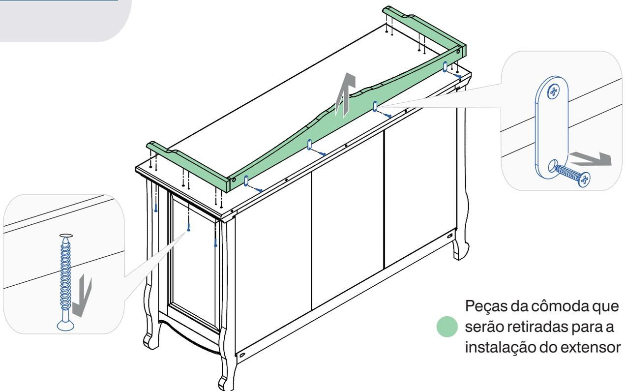
Peças da cômoda que serão retiradas para a instalação do extensor
