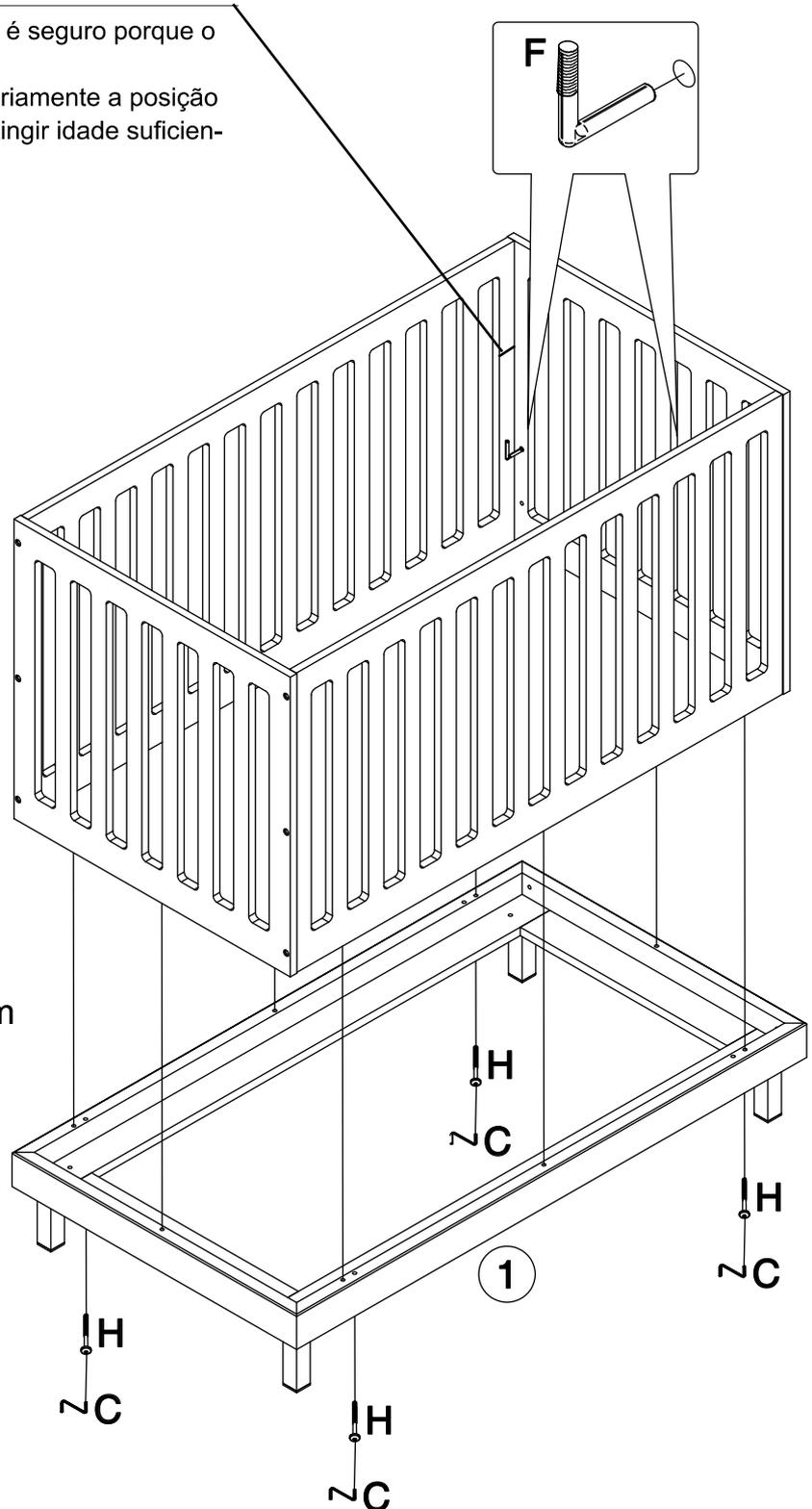
Posicione as laterais montadas em cima da base de forma que as cavilhas fiquem alinhadas com os furos da base.
