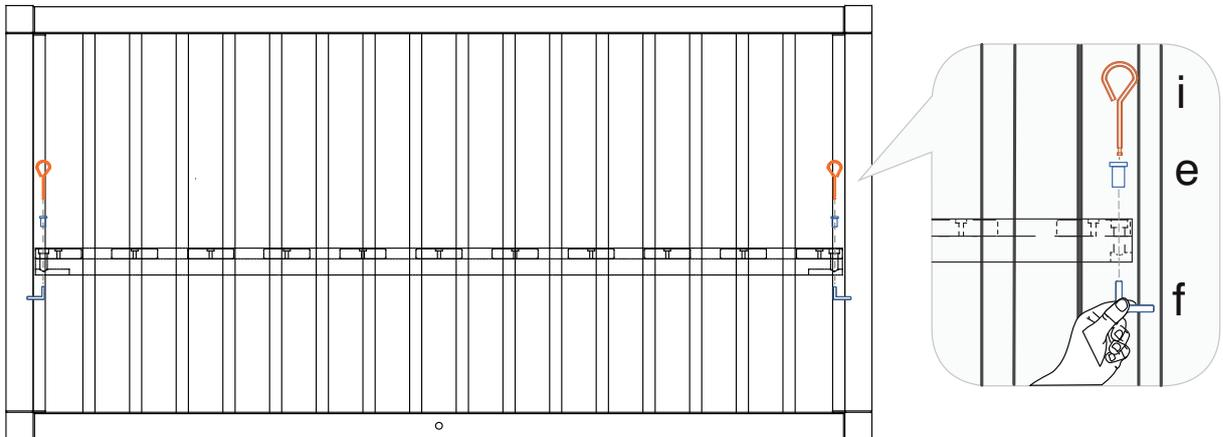
Para facilitar a montagem do estrado, segure a haste da ferragem através da grade lateral do berço, fazendo pequenos movimentos verticais no estrado enquanto direciona a porca com a chave de aperto, com o intuito de centralizar a haste do furo.
