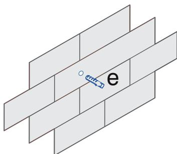
Uma vez escolhida a localização, é sempre bom marcar o local do furo com um lápis, depois posicione a furadeira de forma perpendicular à parede e segure firme executando o furo. **Com a ajuda de um martelo introduza a bucha plástica.**
