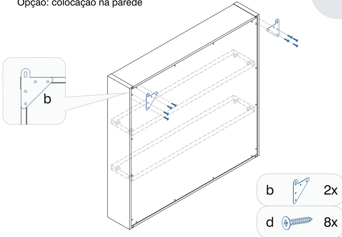
Uma vez escolhida a localização, é sempre bom marcar o local do furo com um lápis, depois posicione a furadeira de forma perpendicular à parede e segure firme executando o furo. **Com a ajuda de um martelo introduza a bucha plástica.**
