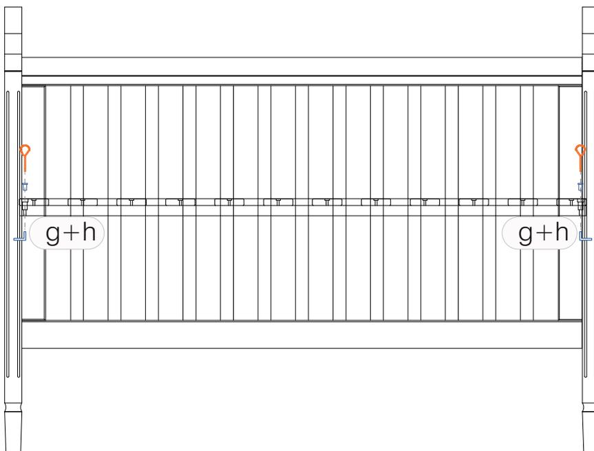
Para facilitar a montagem do estrado, segure a haste da ferragem através da grade lateral do berço, fazendo pequenos movimentos verticais no estrado enquanto direciona a porca com a chave de aperto, com o intuito de centralizar a haste do furo.
