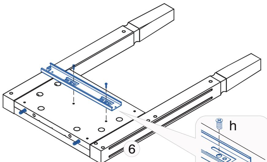
Aplicar o parafuso **h** conforme detalhe abaixo.
