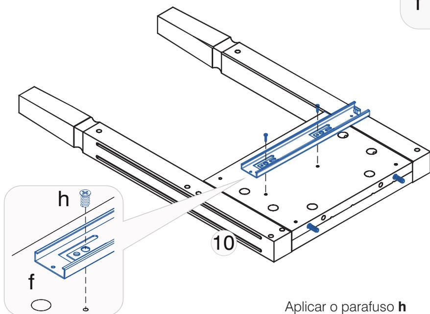
Aplicar o parafuso **h** conforme detalhe abaixo.
