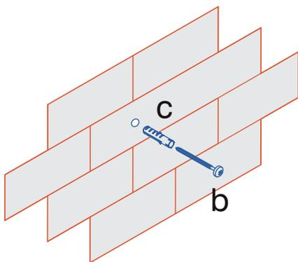
Uma vez escolhida a localização, é sempre bom marcar o local do furo com um lápis, depois posicione a furadeira de forma perpendicular à parede e segure firme executando o furo.
