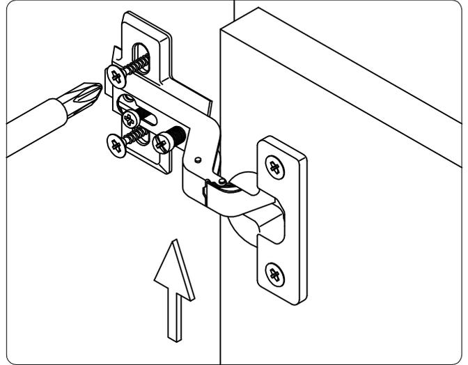
**Se a porta estiver fora de esquadro com relação a estrutura do móvel, ajustá-la apertando ou soltando o parafuso indicado na figura abaixo.**
