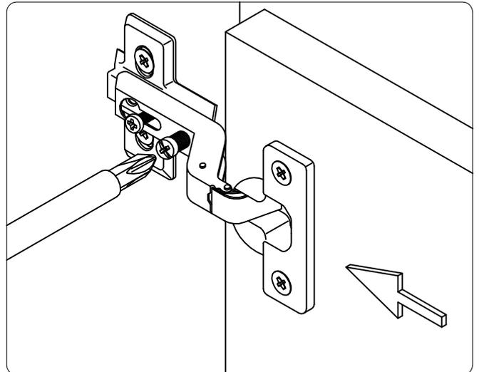
**Para alinhar a profundidade da porta em relação ao quadro do móvel, soltar o parafuso indicado na figura abaixo, posicionar a porta e apertar novamente.**
