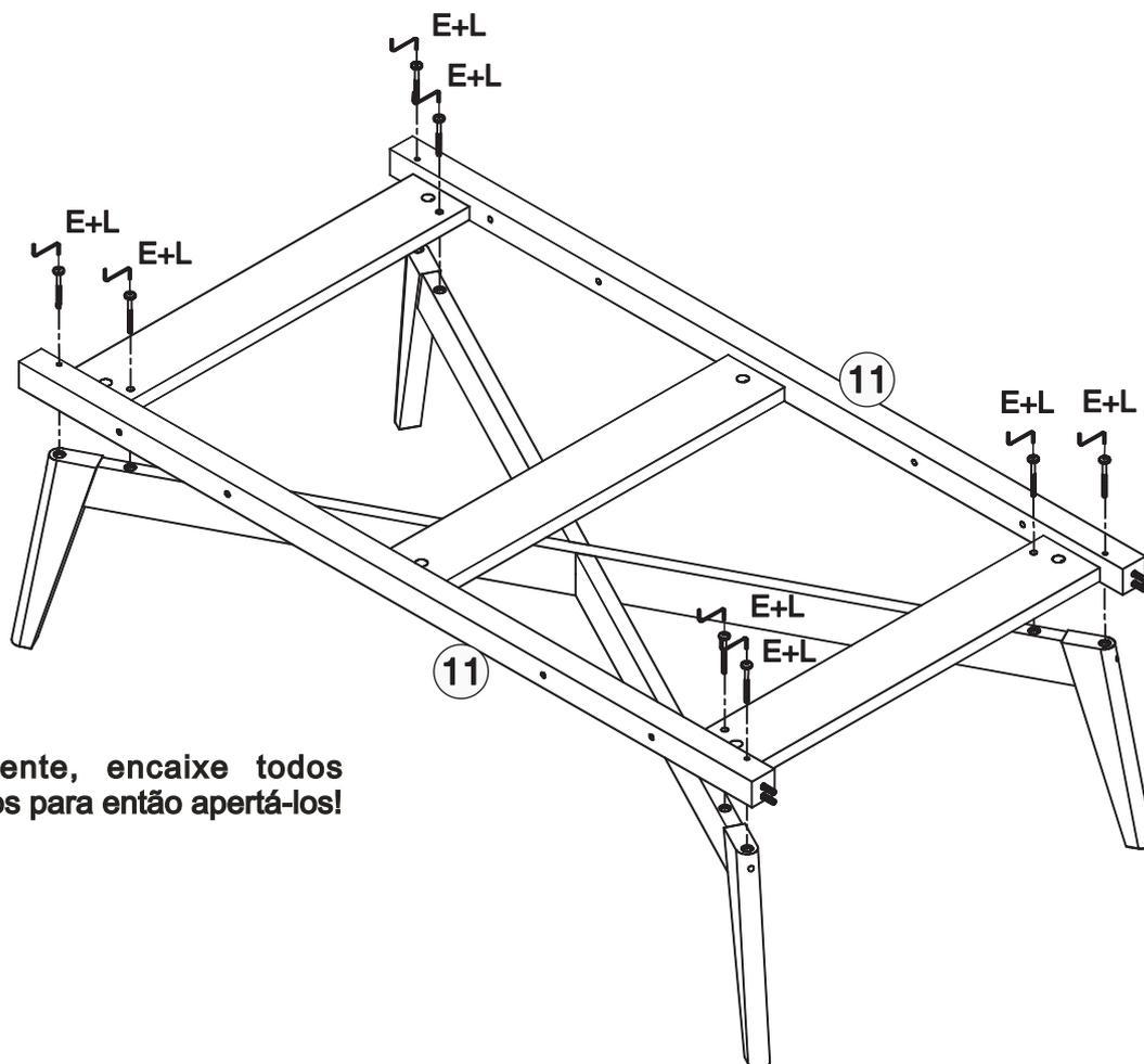
Primeiramente, encaixe todos os parafusos para então apertá-los!
